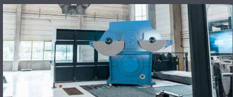
**Großteile-Bearbeitung par excellence** – Die Bauteilgröße macht die geforderte Präzision zur echten Herausforderung. Die Mayer Stahl- und Apparatebau GmbH produziert mit einer unglaublichen Genauigkeit von 0,03 bis 0,05 mm Toleranz bei 18 m Länge der Werkstücke.
