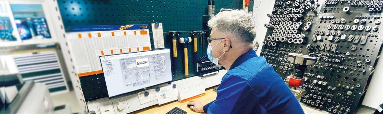
**Runder Workflow** – Der ToolDIRECTOR VM sorgt für ein lückenloses Werkzeug-Datenmanagement vom CAM über die Werkzeugvoreinstellung bis an die Maschine. Werkzeuglisten, Zusammenbauvorschriften, gemessene Werkzeug-Ist-Daten sind nun bei Mayer Stahl- und Apparatebau GmbH 100% digital im Zugriff.
