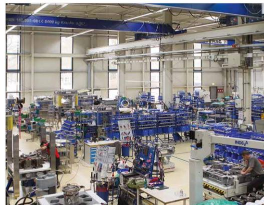
**Lean Production Philosophie** – Die Montageabteilung (Bild) im Schwarzenbeker Werk von FETTE COMPACTING wird im Pull-Prinzip mit Teilen aus der mechanischen Fertigung versorgt.
